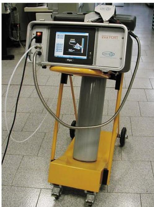
Carrinho leve com duas rodas para transporte (Trolley), com lugar para o espectrômetro e para o cilindro de gás argônio.
